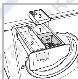
вставьте дополнительный прилагающийся дозатор 3 в ячейку 1. При заливке отбелителя не превышайте "макс." уровень, указанный на стержне в центре (см. схему). Для выполнения только отбеливания без полного цикла стирки залейте отбелитель в дополнительный дозатор 3, выберите программу «Полоскание» и включите дополнительную функцию «Суперстирка» .
